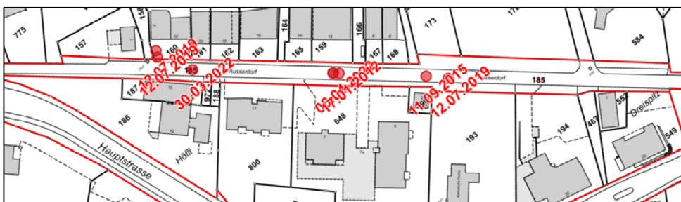
Wasserleitungsbrüche der letzten Jahre im Ausserdorf
